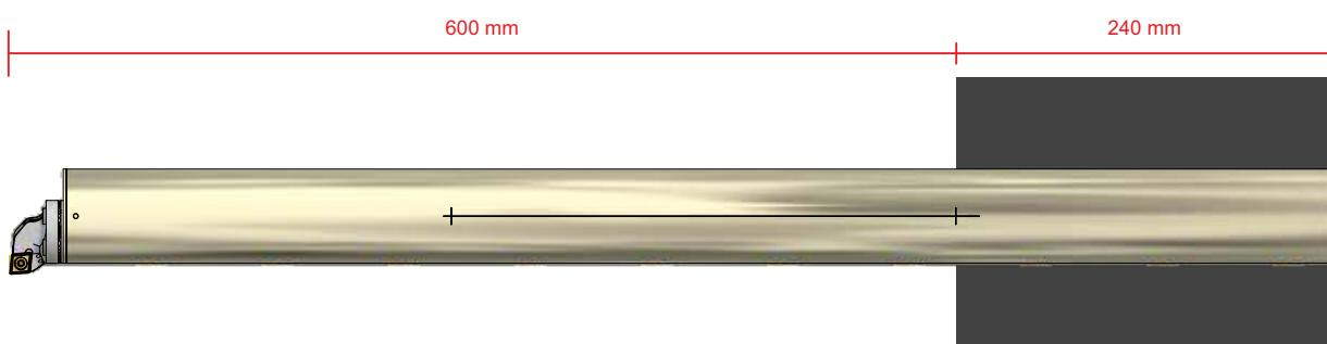
esempio di bloccaggio con barra D 60 mm - 10 x D
